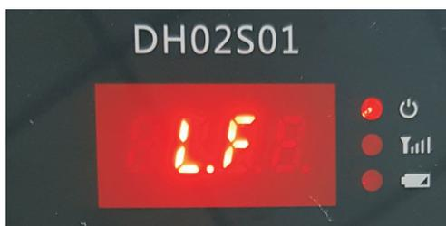
显示“LF”表示失去无线信号；显示“LB”表示电池电量过低；
