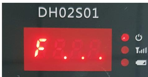
显示“F.....”表示正在寻找无线信号；
