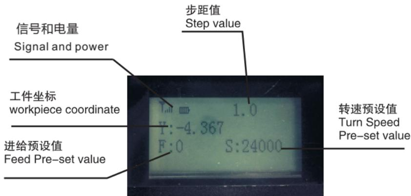
当按下切换按键时，工件坐标变为机械坐标；再次按下该按键，显示工件坐标
