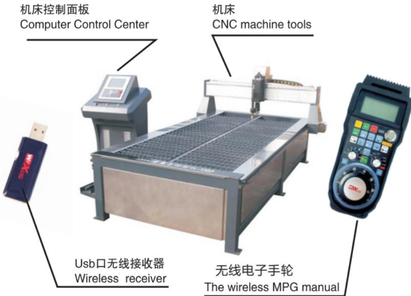
**备注：**为了信号的稳定，请将接收器安装在机箱外面（不能安装在机箱内部）
